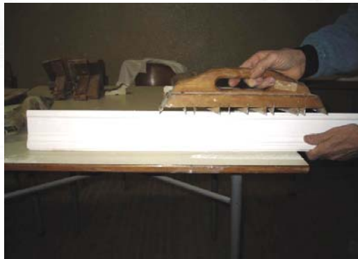
Esempi di alcune cornici in gesso. Finitura con raspa metallica e controllo della sagoma con profilografo ad aghi.
